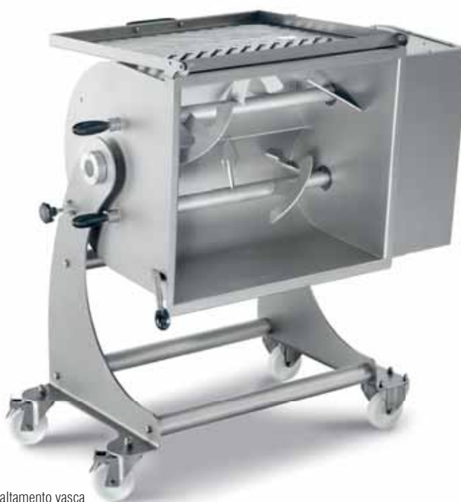
Ribaltamento vasca Tank overturn
