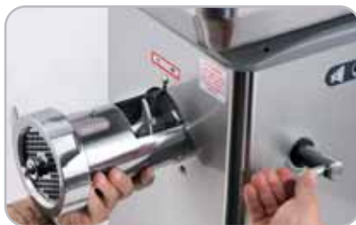
Sblocco bocca Head locking
