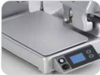
Applicazione bilancia opzionale: Pesata max Kg 10 - precisione gr. 2 piatto smontabile, formato mm 225x360 Optional scale application: Weighing 10 kg max - precision gr. 2 Removable plate, format 225x360 mm
